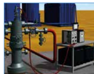
Fig.2 Conexión sensor a cabezal del pozo
